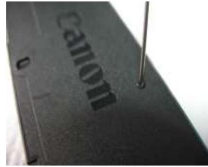
2. Вам необходимо проделать небольшое заправочное отверстие на боковой поверхности картриджа. Отверстие можно проделать иглой от шприца, предварительно раскалив ее зажигалкой. Делать его необходимо в строго определенном месте, под QR-кодом.
